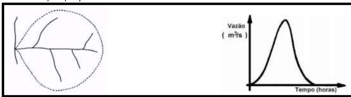
FIGURA 1 - Bacia arredondada e as características do escoamento nela originado por uma precipitação uniforme
