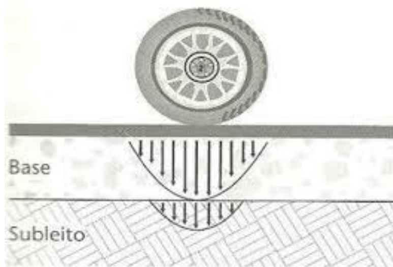
Figura 04 – Resposta Mecânica de Pavimento Flexível.
