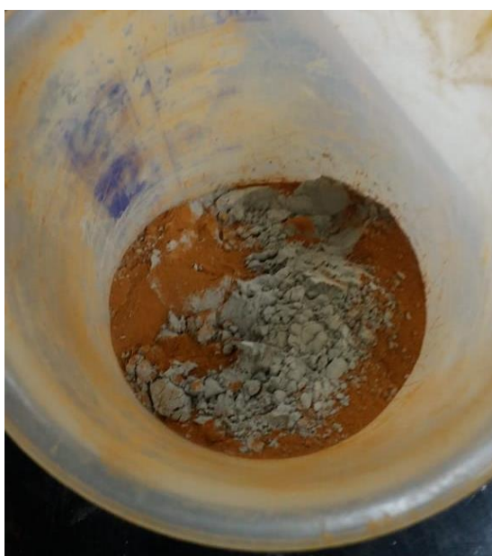
Figura 4 - Mistura de solo e cimento para os ensaios de limite de plasticidade e liquidez. Fonte: Autora (2018).
