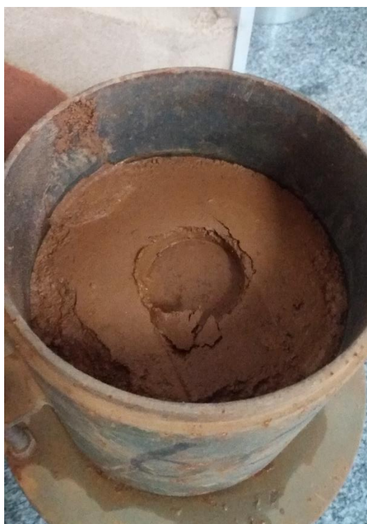
Figura 10 - Estado da amostra de solo natural após os ensaios de CBR e expansão. Fonte: Autora (2018).
