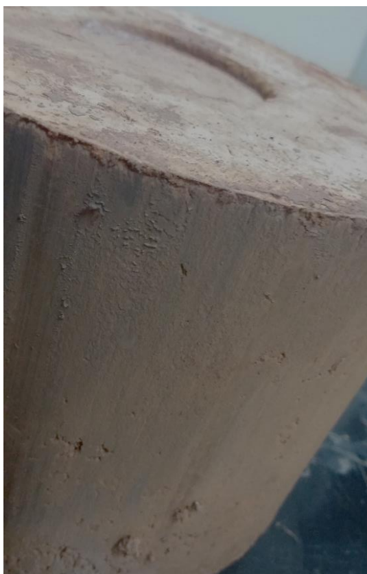
Figura 12 - Estado do solo-cimento após os ensaios de CBR e expansão. Fonte: Autora (2018).
