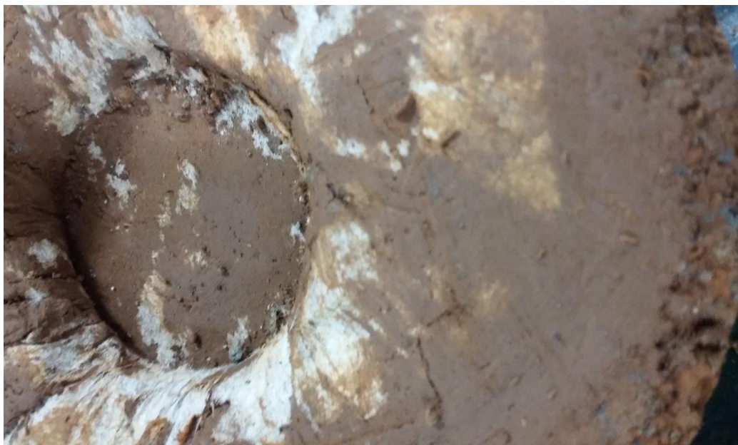
Figura 11 - Estado do solo-sílica após os ensaios de CBR e expansão. Fonte: Autora (2018).
