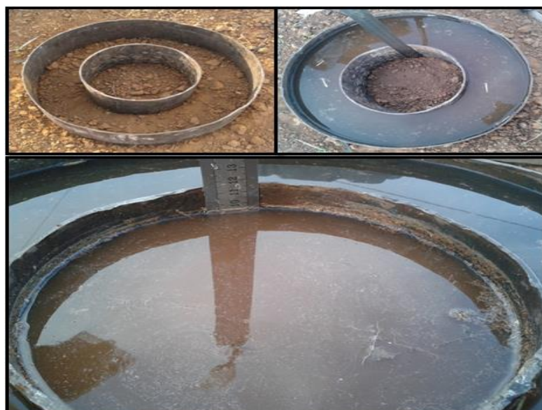
Figura 1 – Ensaio de infiltração
