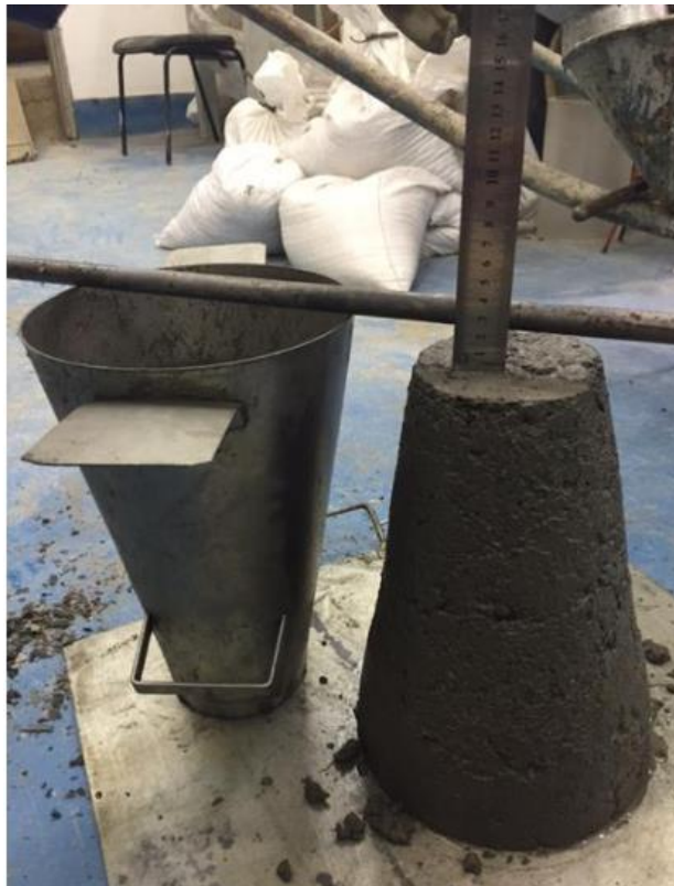
Figura 2 – Ensaio de abatimento de tronco de cone
