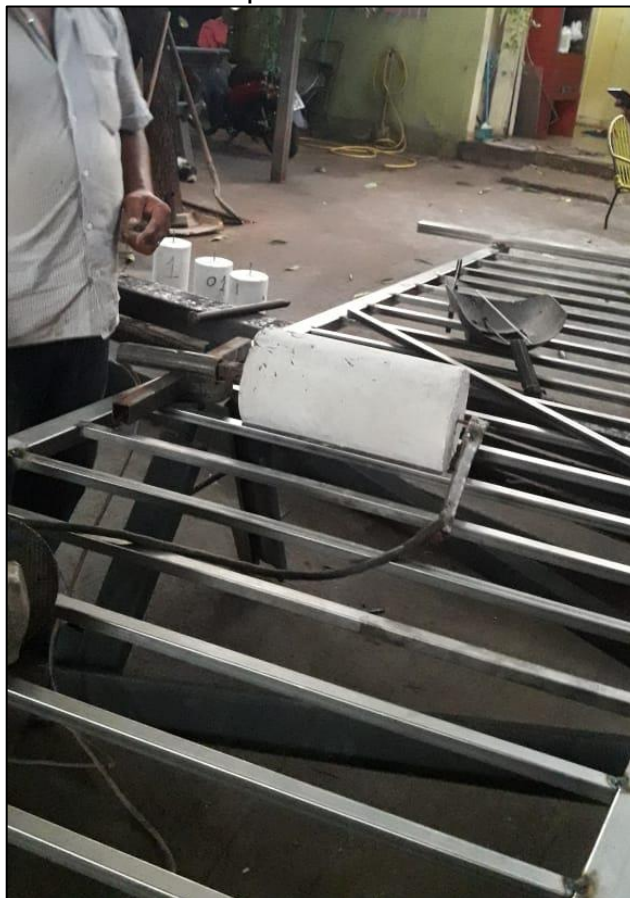
Figura 2 - Preparação do corpo de prova para aplicação da corrente elétrica via máquina de solda.
