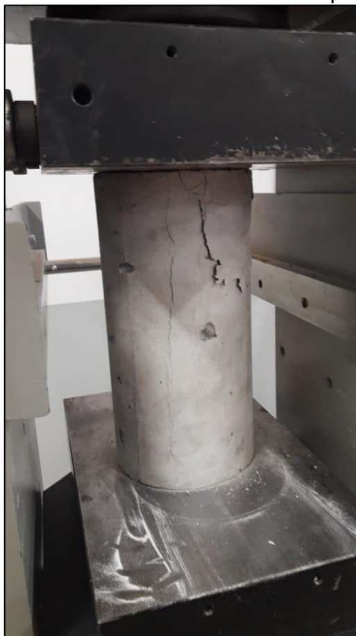
Figura 3 - Ensaio de resistência à compressão.
