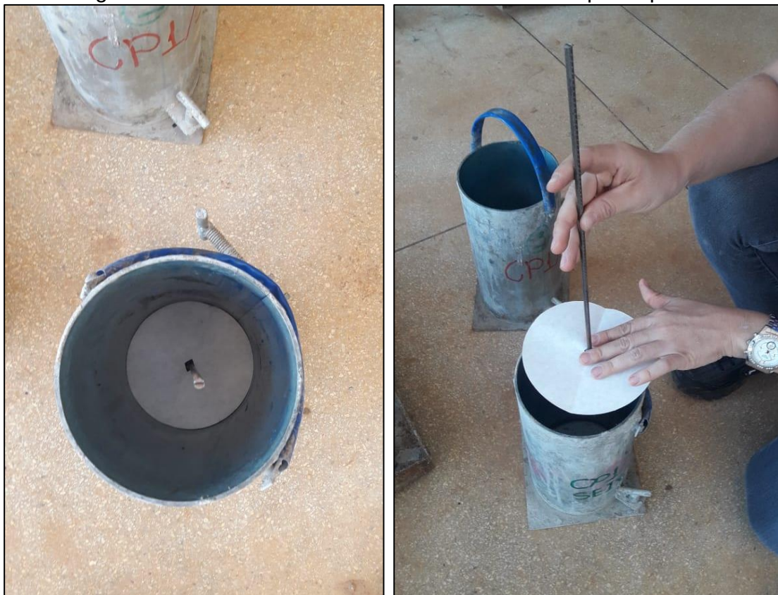
Figura 1 - Haste de ferro no centro da forma de corpo de prova.
