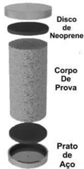
Figura 14 – Representação do corpo de prova nos pratos de aço
