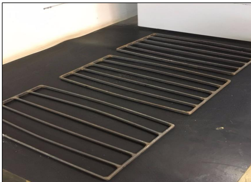
Figura 11 - Estrutura em ferro para moldar e prensar os corpos de prova.
