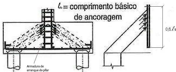
Figura 44 – Detalhe do posicionamento do arranque do pilar
