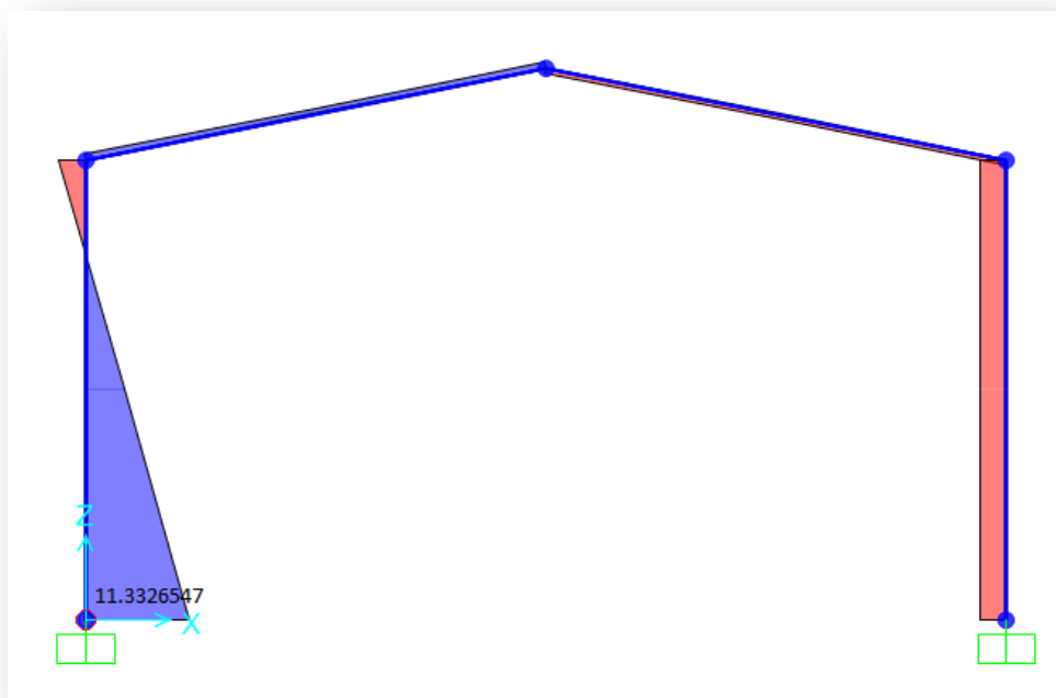
Figura 26- Diagrama de esforço cortante obtido no SAP2000
