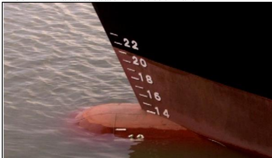
FIGURA 17 - Marcas de calado no casco de um navio
