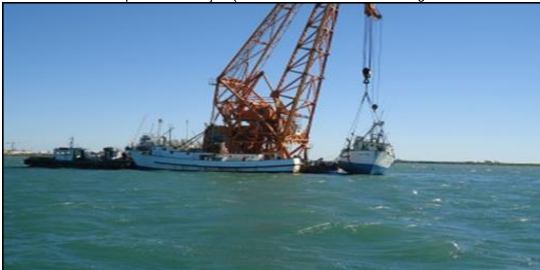
FIGURA 12 - Transporte de serviços (cábrea sendo utilizada em resgate de barco naufragado)
