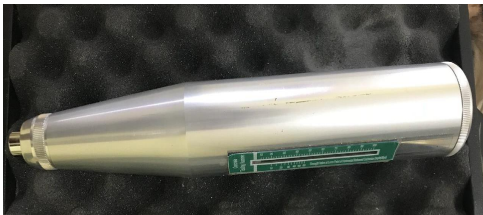
Figura 7 – Esclerômetro de reflexão Fonte: Autor(2018)
