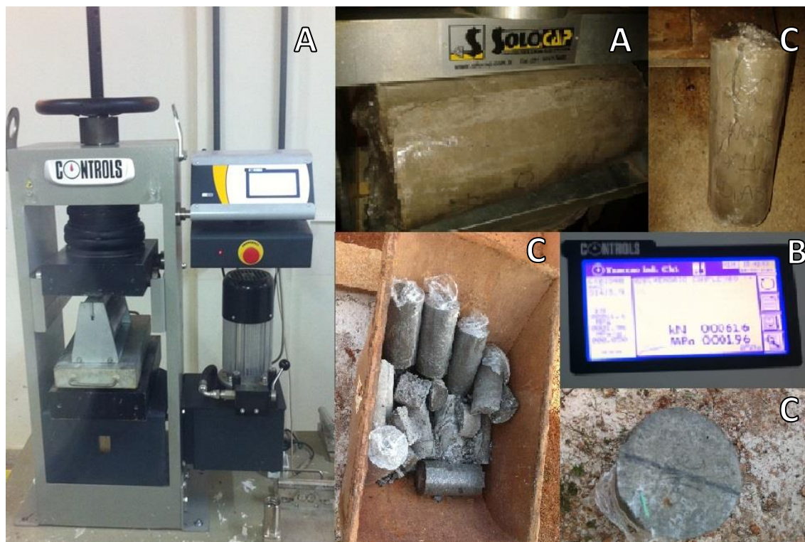
Figura 3 – Ensaio de tração por compressão diametral [ensaio (A), obtenção de dados (B), descarte dos CP's (C)].
