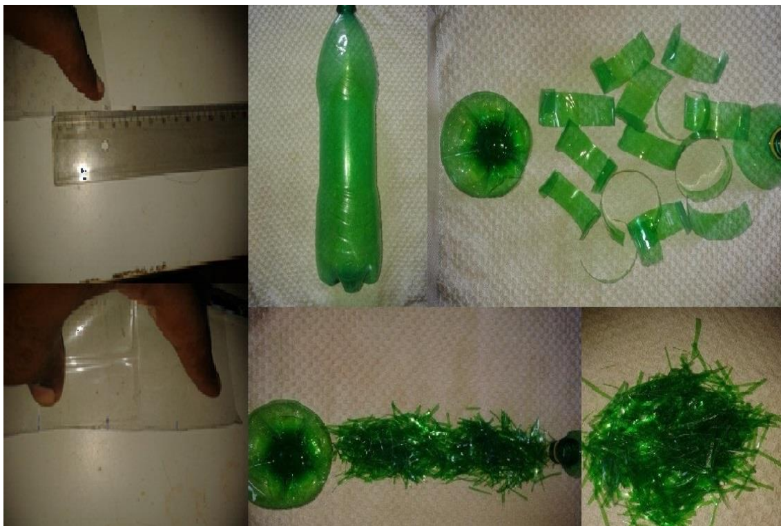
Figura 1 – Obtenção das fibras (demarcação e corte)
