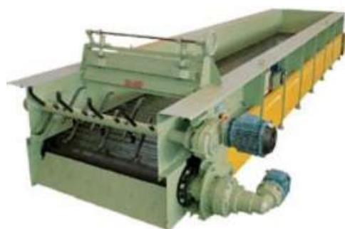
Figura 2A: caixão alimentador
