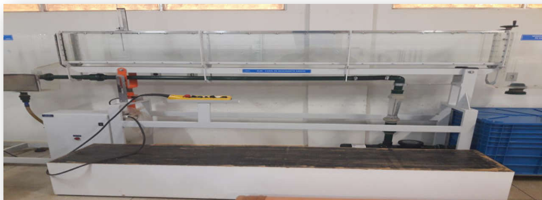
Figura 6- bancada de ensaios canal aberto XL06.1
