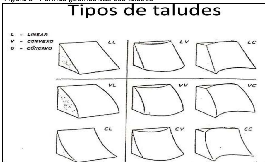
Figura 8 - Formas geométricas dos taludes
