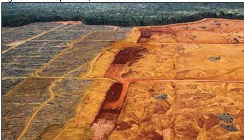
Figura 2 - Lavra por tiras, mina de bauxita no Pará
