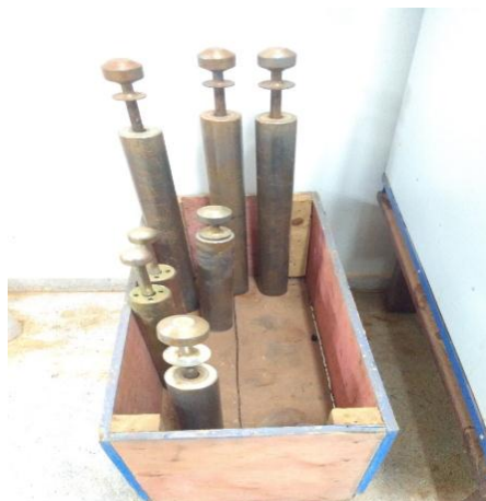
Figura 16 – Soquetes de diferentes energias de compactação
