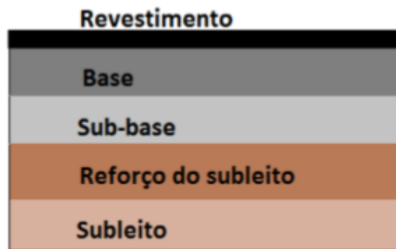
Figura 8 – Camada constituintes de um pavimento flexível
