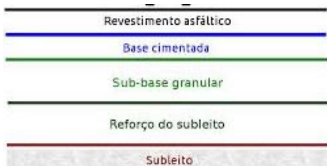
Figura 4: Estrutura de um Pavimento Semirrígido.
