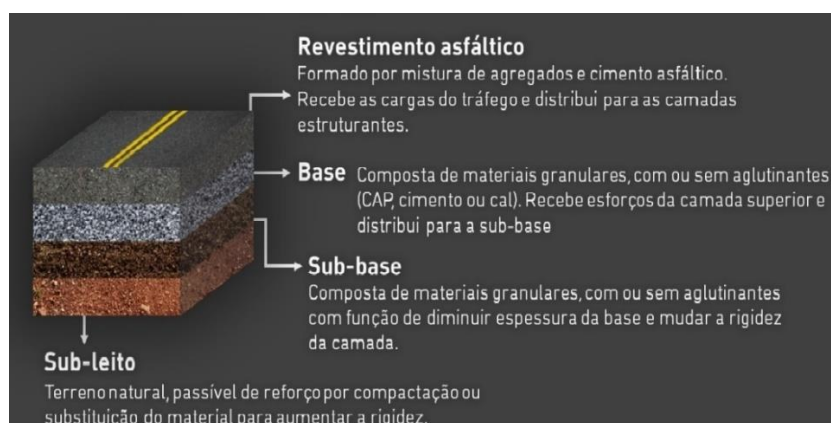
Figura 1: Camadas constituintes de um Pavimento
