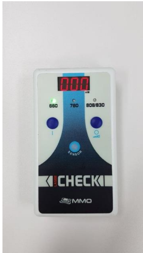
FIGURA 3: Aparelho calibrador. A calibragem do aparelho laser é de fundamental importância para verificação da emissão correta de radiação do aparelho. Valores inferiores a 100 nW, necessitam de uma regulagem do laser, onde vai ser planejado e calculado o tempo de exposição e potência adequada para compensar a descalibragem do aparelho.
