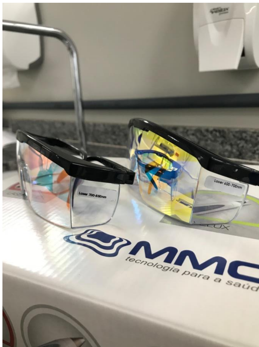
FIGURA 2: Óculos de proteção para o operador. Os óculos de proteção para o operador é específico para cada tipo de laser que será utilizado. O da esquerda é específico para laser com comprimento de onda entre 700 - 850nm (infravermelho), e o da direita, específico para laser vermelho, possuindo comprimento de onda e 600 - 700 nm. Para saber exatamente qual é o comprimento de onda do laser pode-se recorrer ao manual de operações do equipamento laser, ou, caso presente, a plaqueta de identificação no equipamento.
