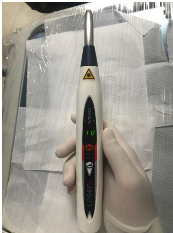
FIGURA 7: Regulagem do tempo de irradiação. Neste aparelho, ao se fazer a escolha do tempo que se pretende fazer a aplicação, se faz também a escolha da potência utilizada. O tempo de 10s corresponde a 1 J de potência e assim por diante.
