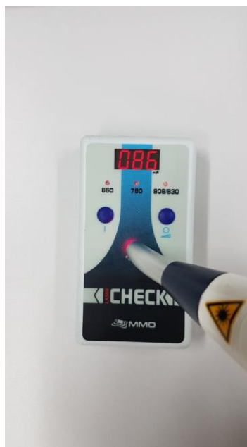
FIGURA 5: Correto posicionamento da ponteira laser sobre o sensor do calibrador. O posicionamento adequado se dá em um ângulo exato de 90°, resultando em uma calibração aceitável.
