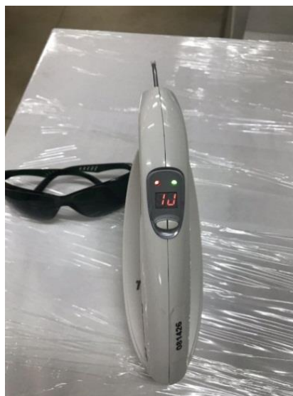
FIGURA 15: Aparelho laser de baixa potência Therapy XT. Aparelho de característica infravermelho e vermelho.
