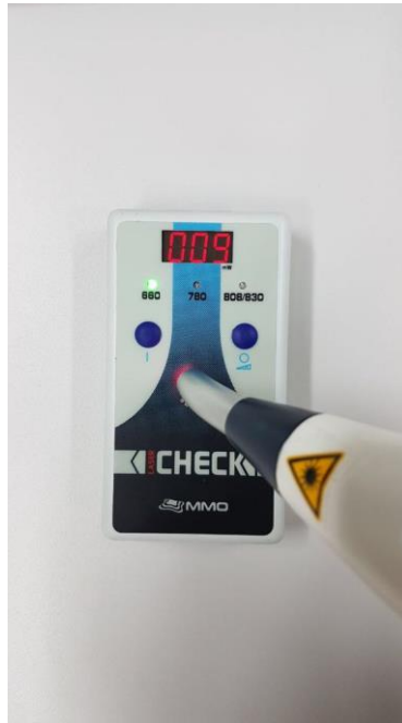
FIGURA 4: Erro no posicionamento da ponteira laser sobre o sensor. A calibragem é um passo de muita importância, onde a negligência ou a realização inadequada, afeta significativamente no sucesso do laser terapia. O mau posicionamento da ponteira laser sobre o sensor do calibrador irá resultar em uma leitura inadequada e insatisfatória da emissão de radiação, necessitando de um reposicionamento e uma reavaliação da calibragem.
