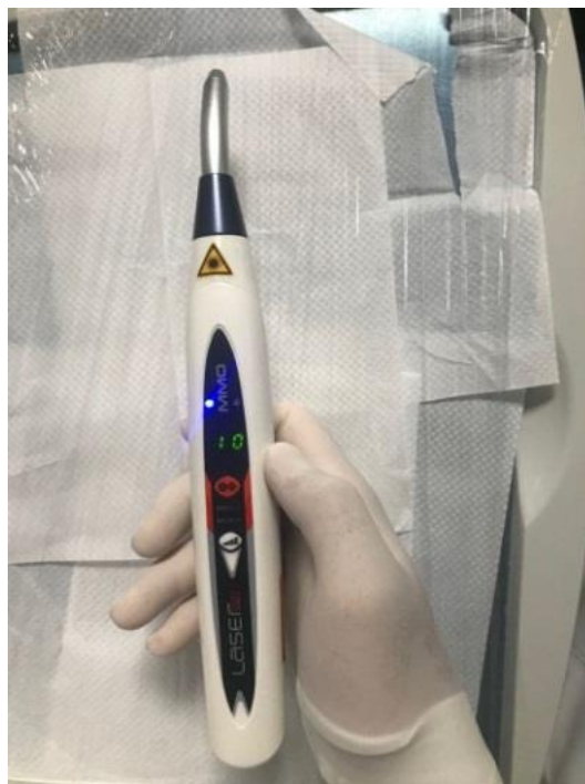
FIGURA 9: Luz de identificação da liberação de radiação. A presença desta luz indica que está tendo liberação de radiação durante a aplicação. Já quando esta luz se encontra piscando incessantemente, indica que o aparelho está descarregando, portanto não se libera radiação.
