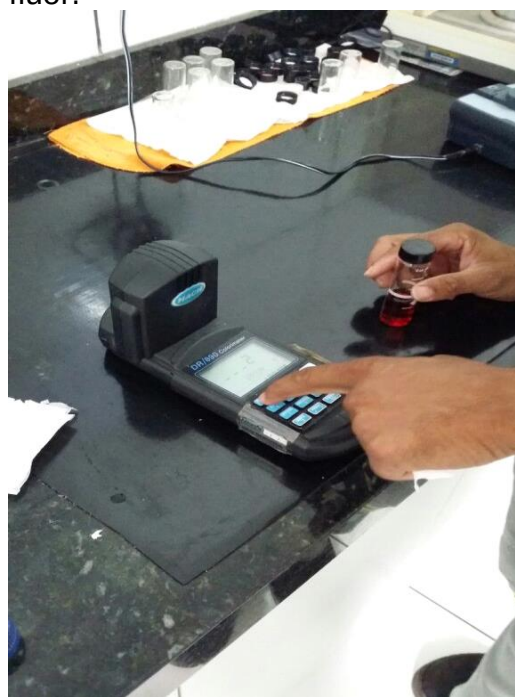
Figura 2 - DR 890 Colorimeter sendo calibrada para medição do flúor.
