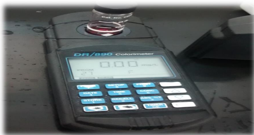
Figura 10 - Máquina dosadora (DR 890 Colorimeter) sendo calibrada para medição do flúor Fonte: (RAFACHO; 2015)
